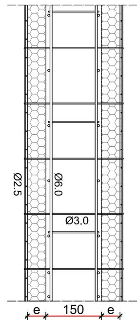
E' necessario ripristinare in opera la continuità delle armature orizzontali in quantità almeno pari a 2 cmq/m.
