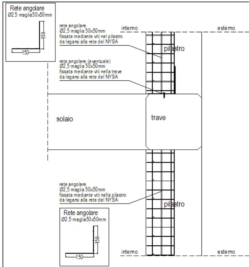
**Figura 7:** Fase 1 – Caso B: sezione verticale del collegamento.
