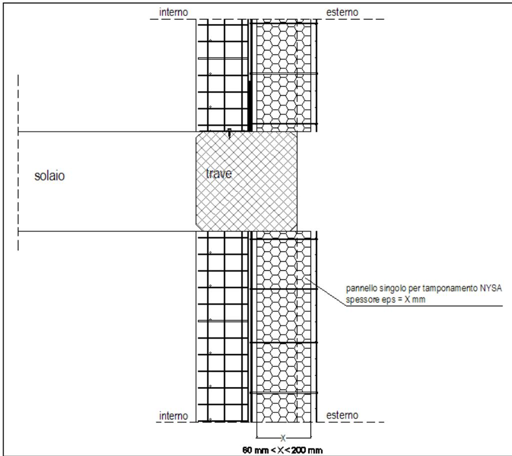
**Figura 9:** Fase 2 – Caso B: sezione verticale del collegamento.
