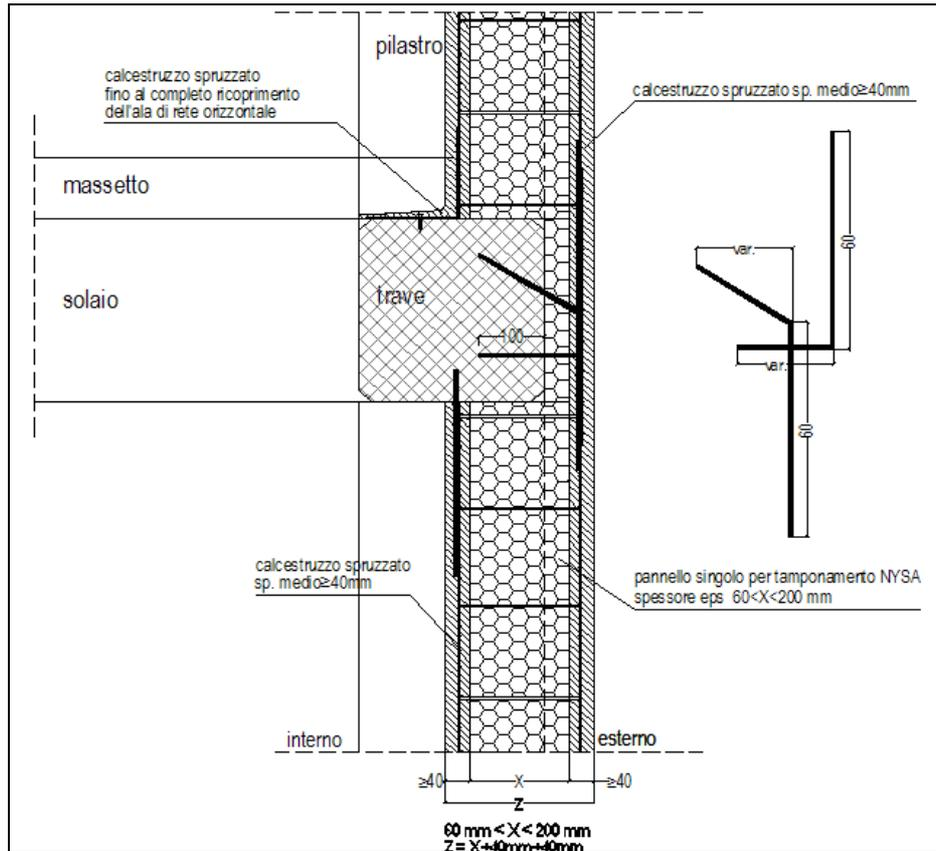
Figura 10: Fasi 3 e 4 - -Casi A e C: sezione verticale del collegamento.
