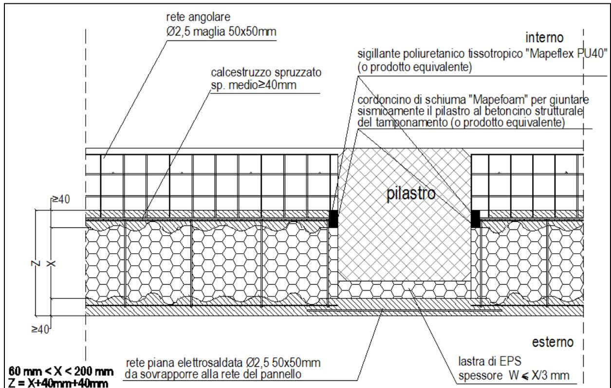
Figura 12: Fase 5 - -Caso C: sezione orizzontale del collegamento.
