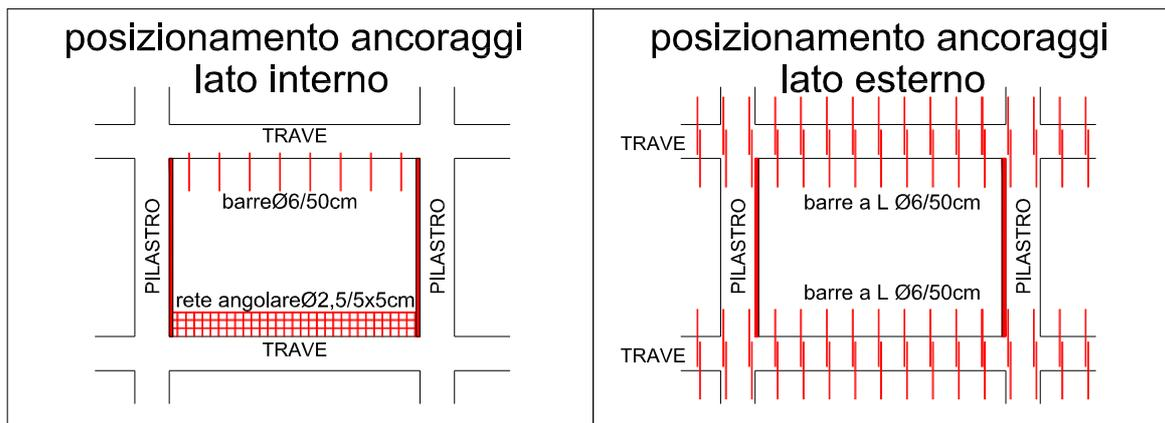
**Figura 4:** Ancoraggi nel Caso C: Pannello NITRA collegato ai pilastri.
