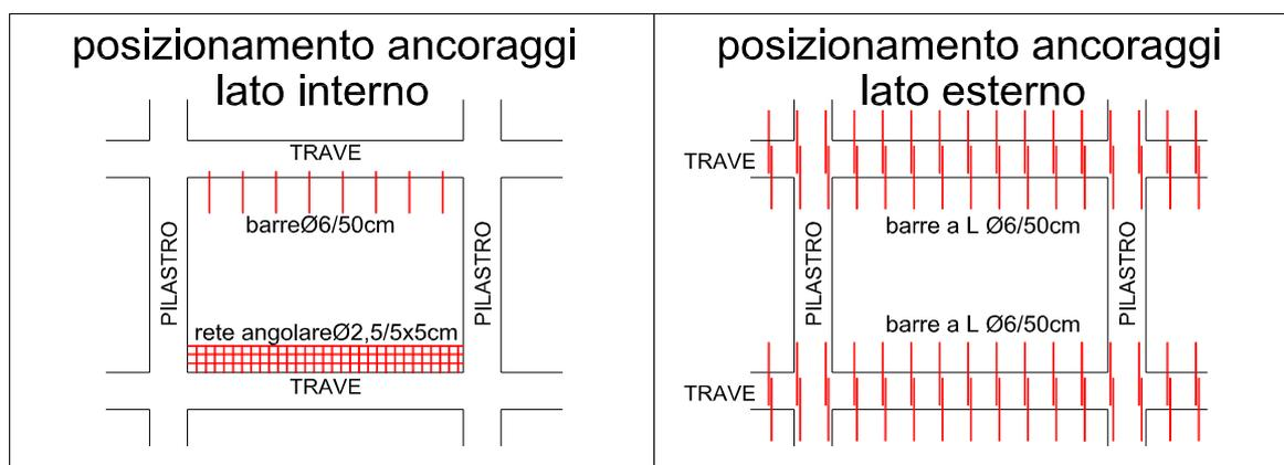
**Figura 2:** Ancoraggi nel Caso A: Pannello NITRA collegato alle travi.
