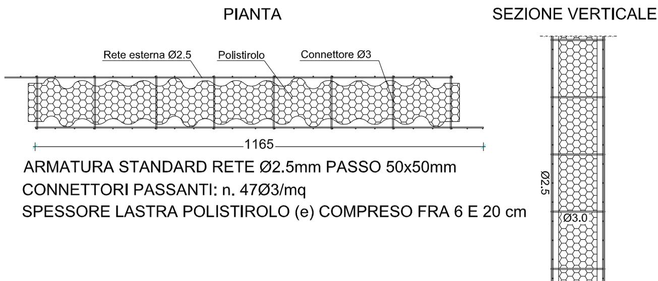
**Figura 5:** Pianta e sezione verticale del pannello singolo di tamponamento, NITRA.
