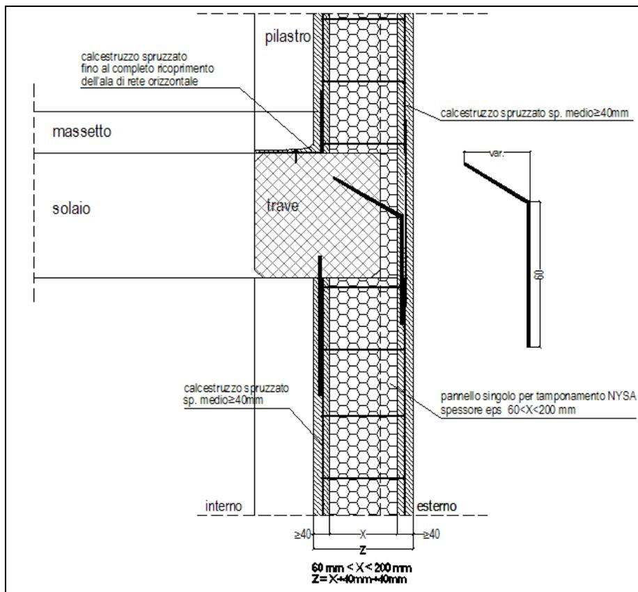
Figura 11: Fasi 3 e 4 - -Caso B: sezione verticale del collegamento.
