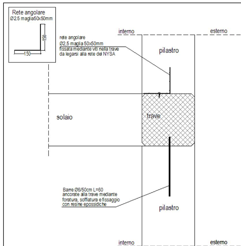
**Figura 6:** Fase 1 - -Casi A e C: sezione verticale del collegamento.
