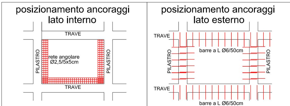
**Figura 3:** Ancoraggi nel Caso B: Pannello NITRA collegato ai pilastri.
