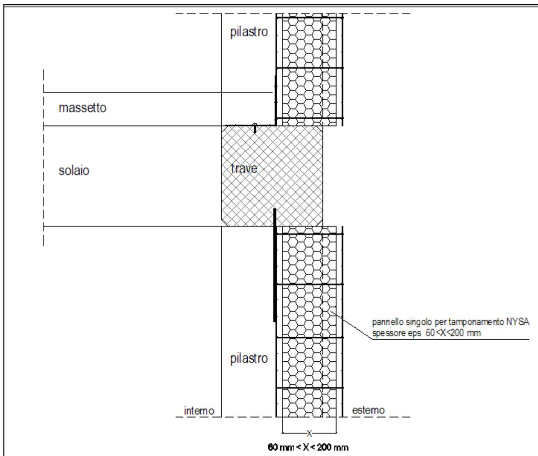
**Figura 8:** Fase 2 - -Casi A e C: sezione verticale del collegamento.
